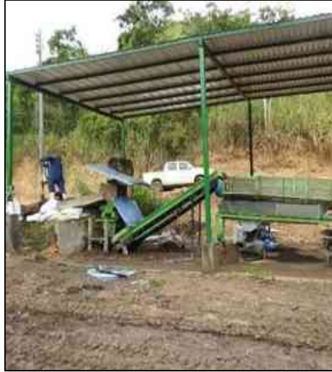
Fotografía. Trituración y cernido del compost maduro.
