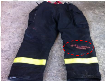
Dos equipos presentan decoloración por contacto con el fuego, y altas temperaturas generadas en atención de emergencias.
