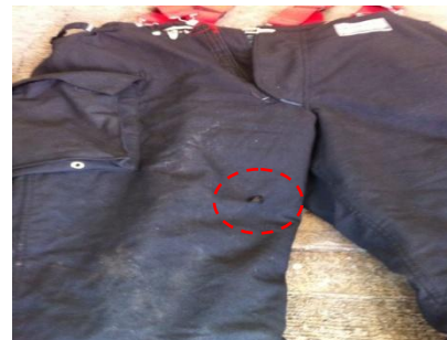
Un equipo presenta una rasgadura y/o rotura posiblemente con el contacto con un objeto corto punzante al momento de cubrir una emergencia.
